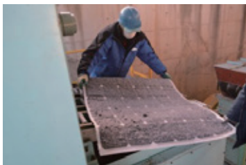
分離されたバックシート
