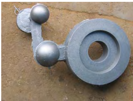
図.4 鋳込テスト品の外観写真（本開発プロセス） 結果として、本開発プロセス品を使用して鋳造した鋳物は、塗型無しでも良好な鋳肌が得られた（図4）。
