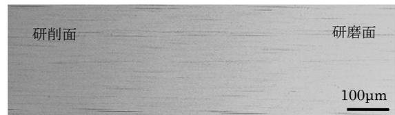
図 1.6 研磨試験片のき裂(点荷重)
