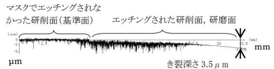
図 1.7 研磨試験片の断面形状とき裂深さ(点荷重)
