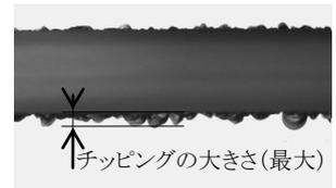
図 2.2 チッピングの測定
