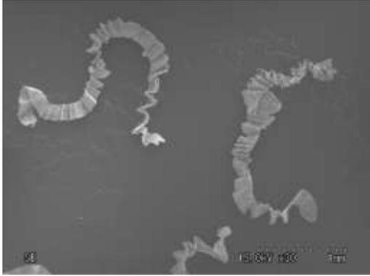
図8 切り屑形状 (工具 M、No. 1)
