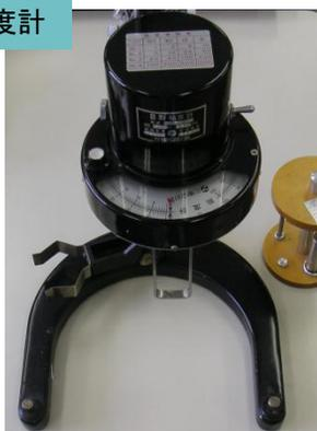
食品用圧縮試験装置による餅の測定例
