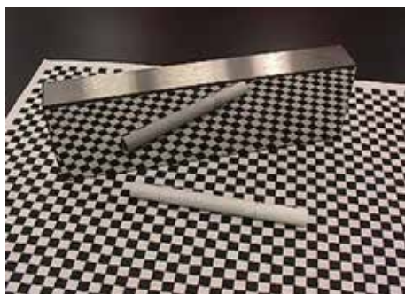
金型材(SUS440C)の 鏡面平面研削加工事例
