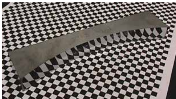
自由曲面の超精密鏡面研削加工事例
