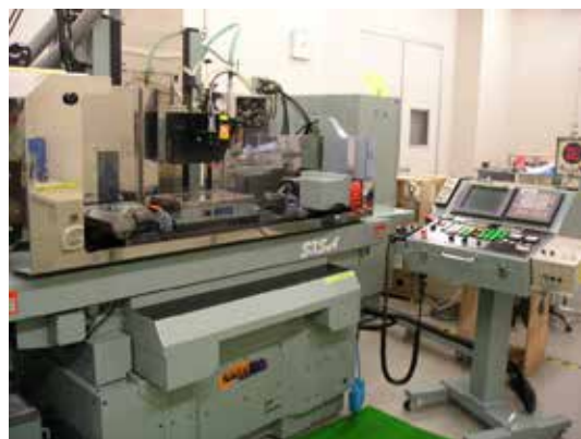
研削による自由曲面加工が出来る 超精密CNC成形平面研削盤
