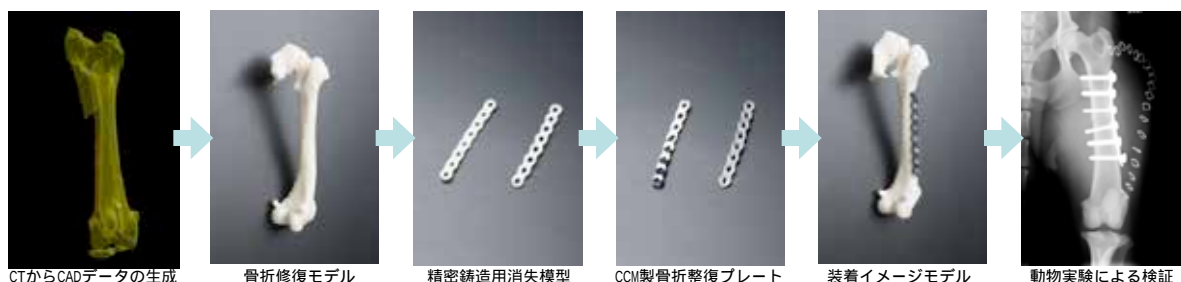
図3 小型犬用骨折整復プレート製作の流れ
