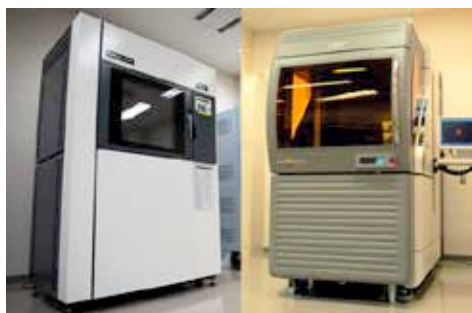
図1 ラピッドプロトタイピング装置 (左：熱溶解積層法式、右：光造形法式)
