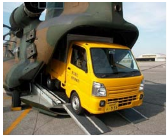
空輸対応型低圧応急用電源車(東北電力株)
