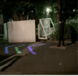
夜間の歩行者・ドライバーへの注意喚起と飛び出し抑止を図る、踏切への視線照射（プロジェクションAR）
