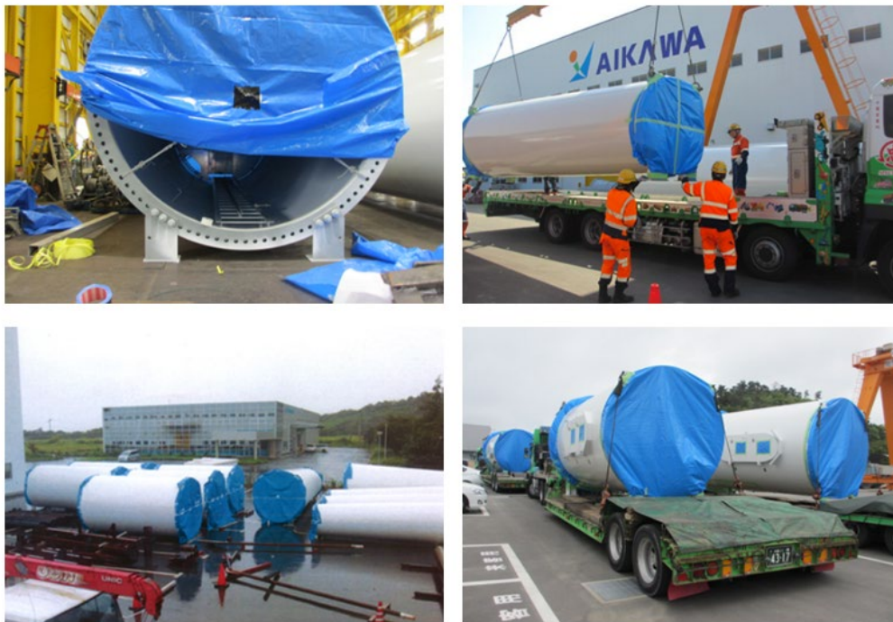
図 6-10 タワー部の製造 (出典：会川鉄工 HP)
