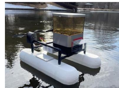
[小型給餌／薬剤散布ロボット 実機]
