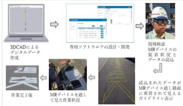
現場で装着可能なMRデバイスを活用し標示図形をリアルタイムで路面に重畳表示するシステムを独自開発。現場での作図作業の効率化に成功！
