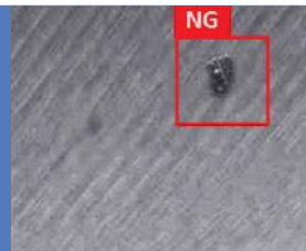
金属面鑄造欠陥の検出例
