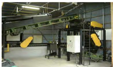
コンボスパット材と有機廃棄物を混合攪拌するための前処理機械
