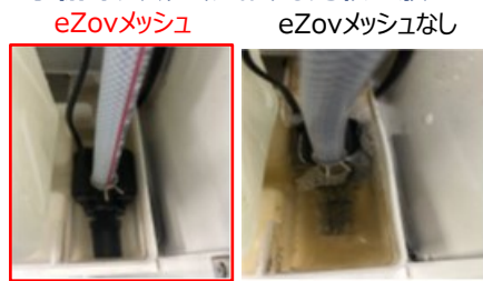
同時に試験を開始した4週間の稼働後の状態比較（微生物の増殖が抑えられている）
