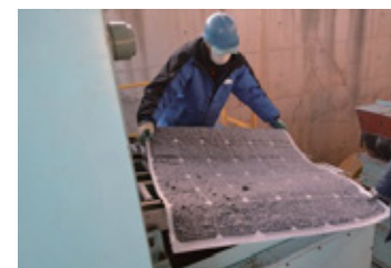
分離されたバックシート
