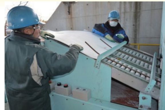
パネルをガラスわけーⅡ型に投入
