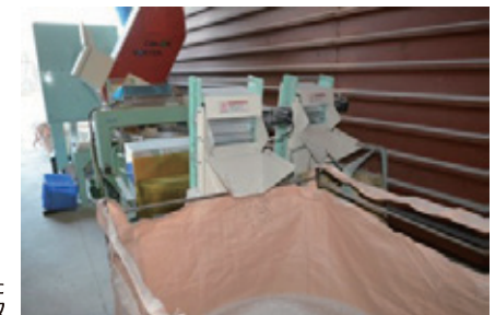
破碎されたガラスを回収
