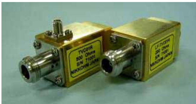
産業技術総合研究所と共同開発した交直差 1 ppm、マルチジャンクションサーマルコンバータ
