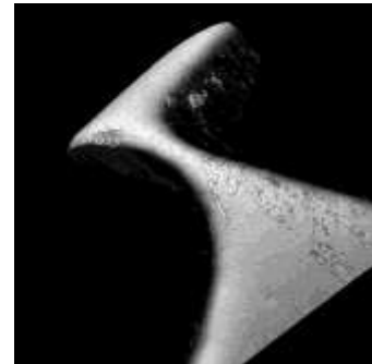
エンドミル刃先の表面加工拡大監察図
