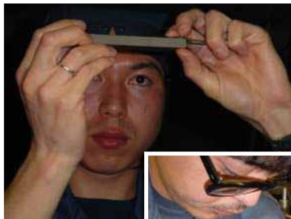
5μm 単位の刃と刃 の隙間を調整
