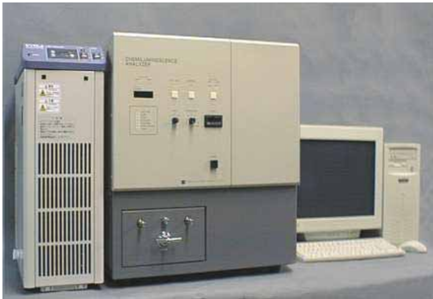
極微弱発光検出分光システム(中央の機器がケミルミネッセンスアナライザー)
