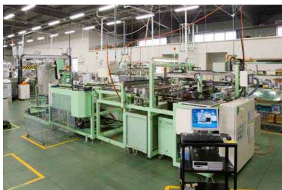
一貫生産によるバックミラー製造ライン
