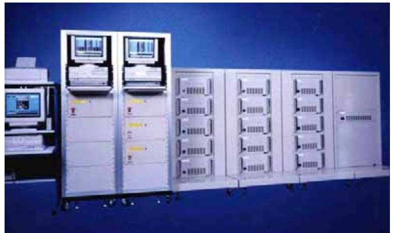
電池の性能を評価する「充放電評価装置」
