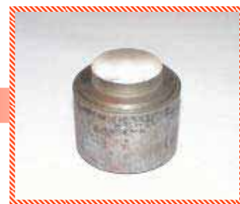
鉄の穴に-30℃に冷やした 亚克力ガラスをはめ込む 「はめ合い」の技術
