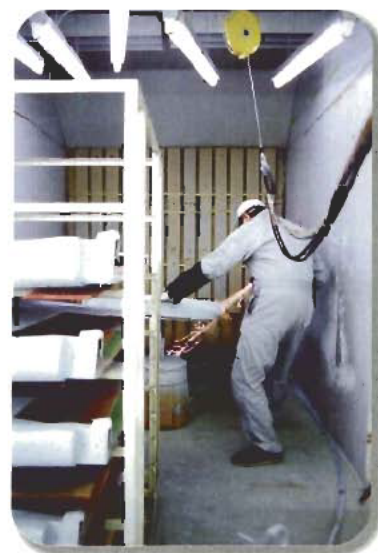
坂本乙造商店の金属溶射技術を使って、 漆塗装を施している現場の様子。
