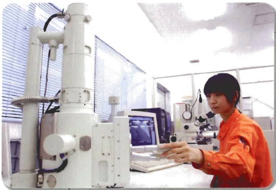
電子顕微鏡を使ってエンドミルの状態を確認する高野良子さん。
