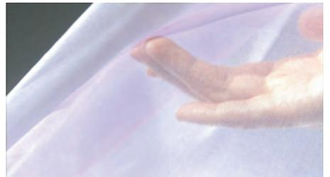
1.6デニールの繭を用いて14デニール（外径0.1mm以下）の超極細生糸を新規に開発（通常は3デニール繭から20デニール生糸を作製）
