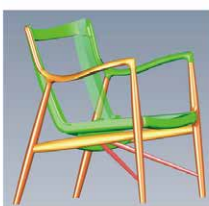
フル3D CADによるデジタルモデリング を行い、各木部パーツはすべてNCに よる加工
