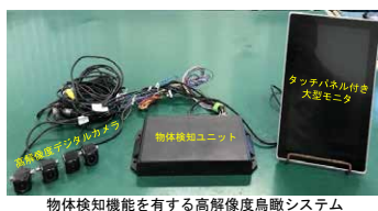
物体検知機能を有する高解像度鳥瞰システム
