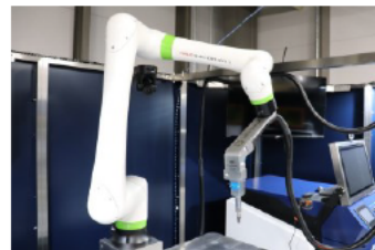
▲協働ロボットによる溶接工程の自動化
