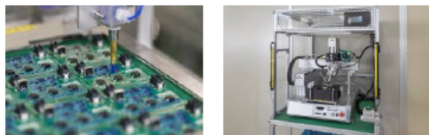
▲防湿剤自動塗布装置／はんだ付けロボット
