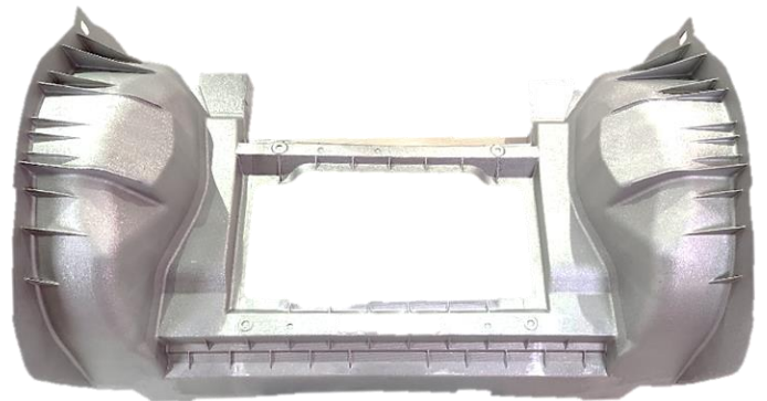
EV車用リアフレーム アルミニウム鋳物 外寸：1650×850×700mm 平均肉厚：3.5mm
