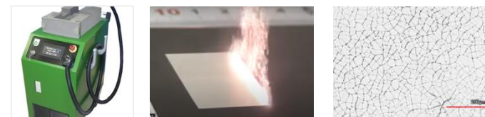
（左・図1）東成エレクトロビーム社のレーザー洗浄機「イレーザー®70W」 （中央・図2）亜鉛メッキ鋼板の耐熱塗装をレーザーで除去する様子 （右・図3）レーザー照射後に金型のメッキに生じたしわ
