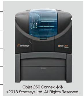
この装置では、インクジェットノズルからモデル材料とサポート材料(どちらも光硬化性樹脂)を吐出し、同時にUVランプが走査して硬化させていきます。超薄積層による優れた精度により、極めて精密な細部と卓越した表面仕上げが得られると共に、物性の異なる樹脂を混合させた新しい特性を持つ材料を同時に造形することができます。
